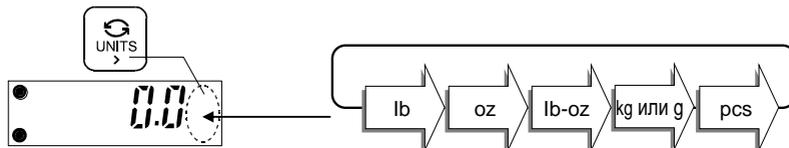
С помощью функциональной установки “ $\sigma\tau$ -g” можно переключить, “kg” и “g”.
