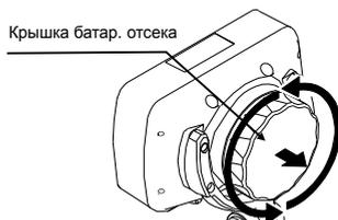
3. Соблюдая полярность, вставьте батарейку в отсек. Полярность обозначена внутри батарейного отсека. Сначала вставьте отрицательный конец батарейки. Надавите на положительный конец, чтобы вставить батарейку в отсек (см. рис. справа).
