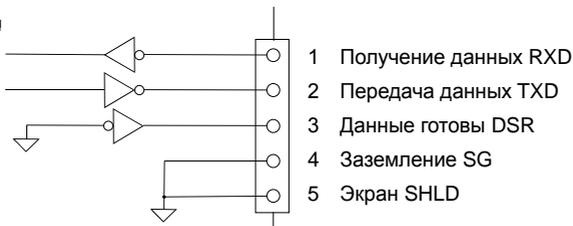
❑ Весы SW являются DCE оборудованием (для передачи данных).
