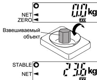
Переключатель **ZERO** обнулит весы, если значение веса находится в пределах  $\pm 2\%$  НПВ (кг) относительно нулевой точки при включении. При этом включается индикатор ZERO ◀. Если значение веса превышает  $\pm 2\%$  НПВ (кг), переключатель **ZERO** не работает.
