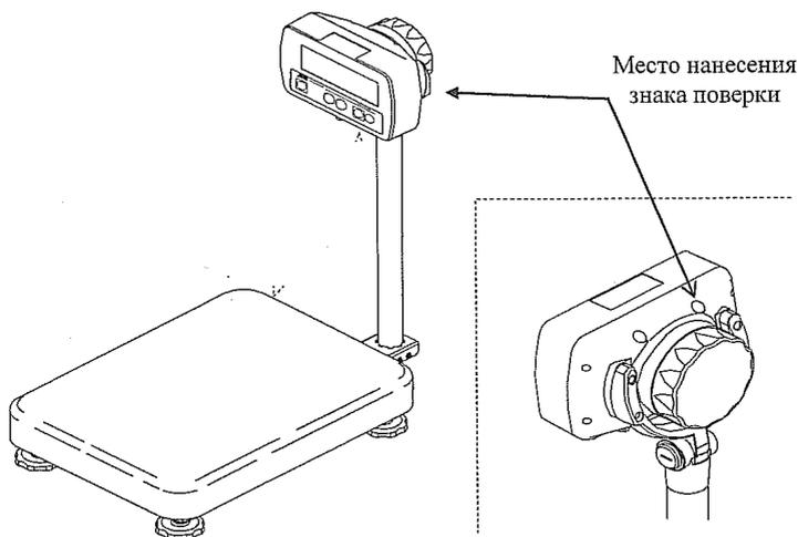
Рисунок 2 - Схема пломбировки от несанкционированного доступа, обозначение места нанесения знака проверки
